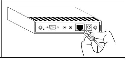
Inserte el extensor IR en el conector para extensor IR.
