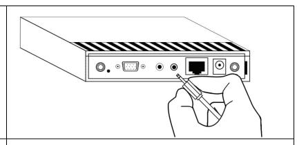
Inserte el cable de audio en el conector de la salida de audio y conecte el otro extremo del cable al conector de entrada de audio de su proyector o amplificador de audio.
