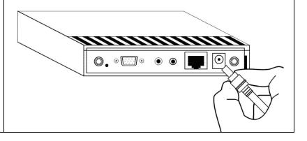
Conecte el adaptador de alimentación de CA al tomacorriente de la pared.
