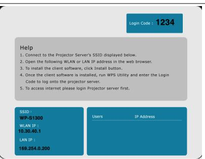
Inicie el Internet Explorer, Firefox o cualquier navegador Web e introduzca la dirección IP del servidor de proyector en la barra de direcciones.
